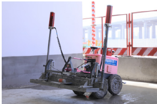
混凝土地面整平机器人
